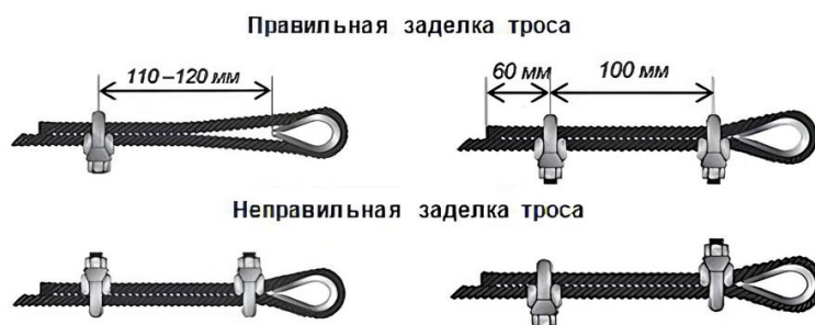
Рисунок 6 – Заделка троса
